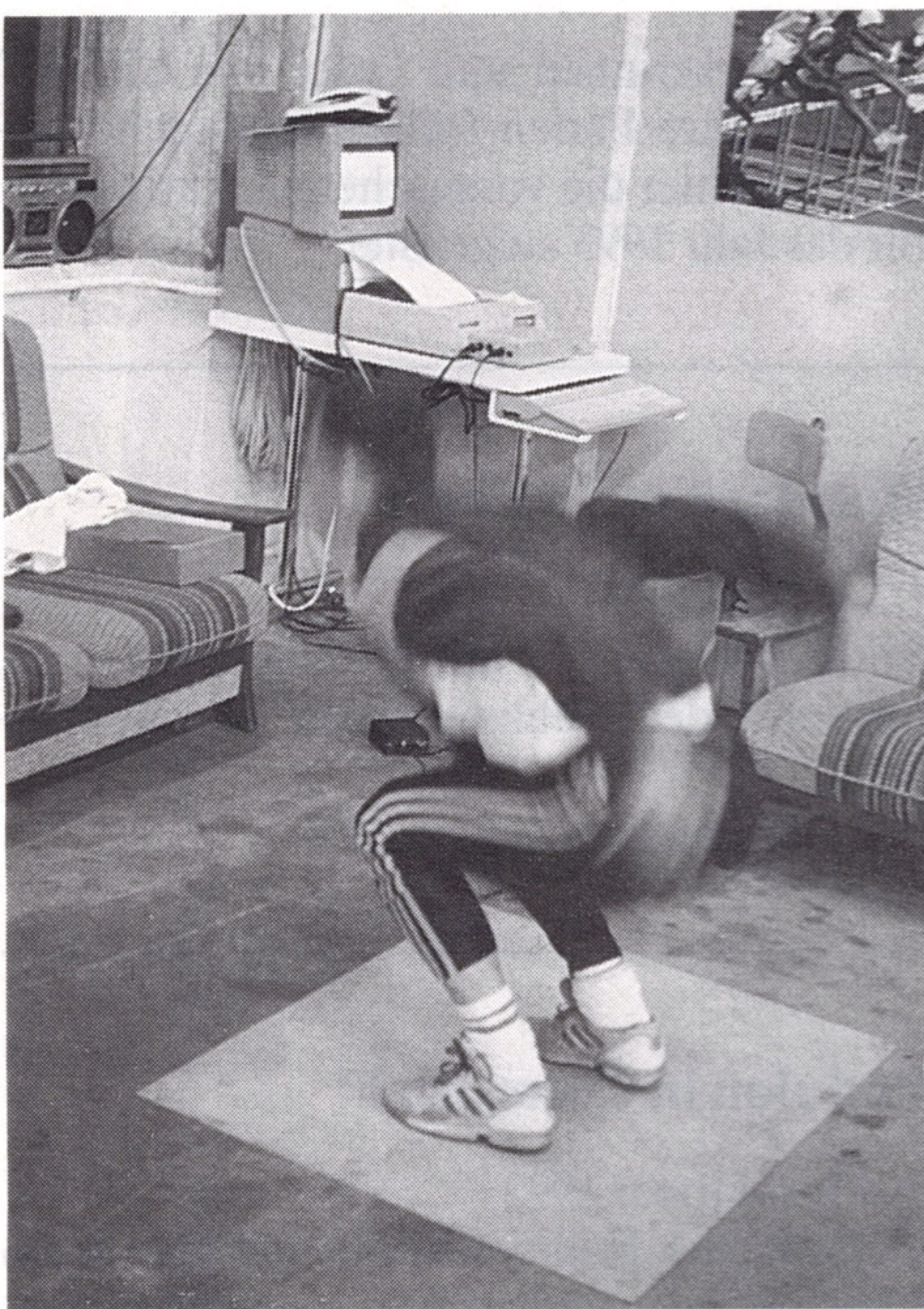
Messen der maximalen und relativen Sprungkraft an demselben Feedback-/Computersystem zwecks Kontrolle der Aktivierungsmessungen (und zur Steuerung des Krafttrainings)
